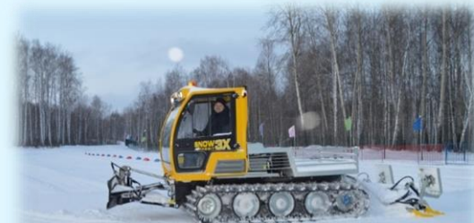
Ретрак - специальное транспортное средство, используемое для подготовки лыжных трасс
